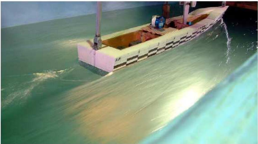
Fig. 5.23 Wave Pattern( $V_s = 22.5$  Knot)
