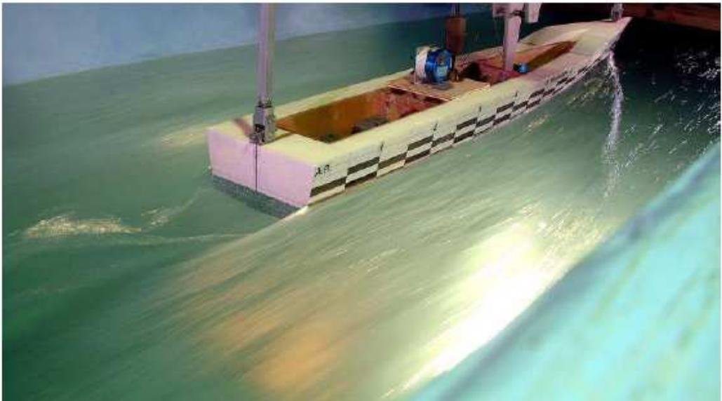
Fig. 5.24 Wave Pattern( $V_s = 25.0$  Knot)
