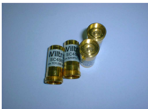
그림 2.5 Wiltron사의 Sample Holder Fig. 2.5 Sample Holder of Wiltron.
