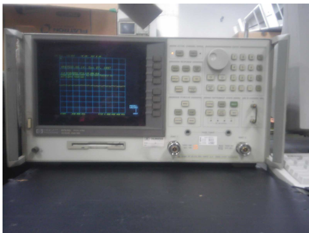
그림 2.4 HP(Hewlett Packard) 8753D 네트워크 아날라이저 Fig. 2.4 HP(Hewlett Packard) 8753D Network Analyzer.
