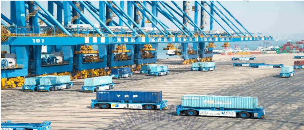
<그림 2-2> 중국칭다오 QQCT 자동화 컨테이너터미널(안벽-야드 자동이송작업)
