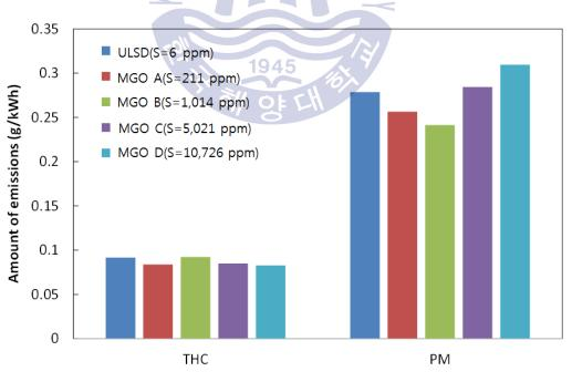
Fig. 4.26 E3 사이클에서 연료 조성 변화에 따른 THC, PM 배출량 측정 결과
