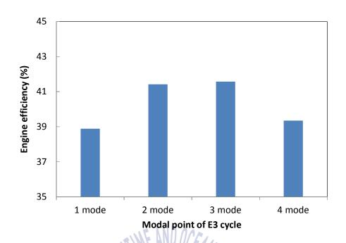
Fig. 4.25 E3 사이클 각 모드별 엔진 효율 측정 결과(ULSD 사용)
