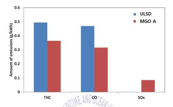
Fig. 4.18 E3 사이클에서 연료 변화에 따른 THC, CO, SOx 배출량 측정 결과
