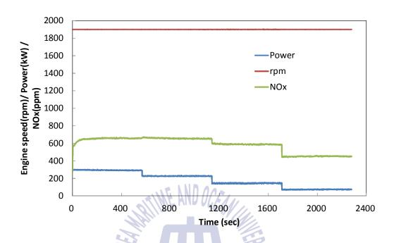
Fig. 4.20 E2 사이클 운전에 따른 출력, 엔진 회전수, NOx 배출량 측정 결과(사용연료: ULSD)
