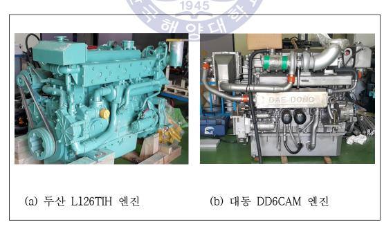
Fig. 4.1 엔진시험용 소형고속디젤엔진의 모습
