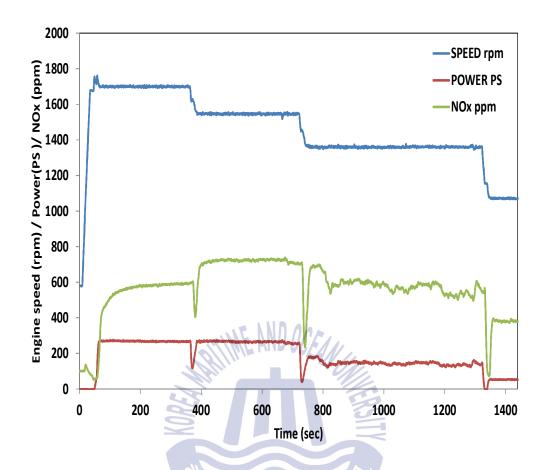
Fig. 4.17 E3 사이클 운전에 따른 출력, 엔진 회전수, NOx 배출량 측정 결과
