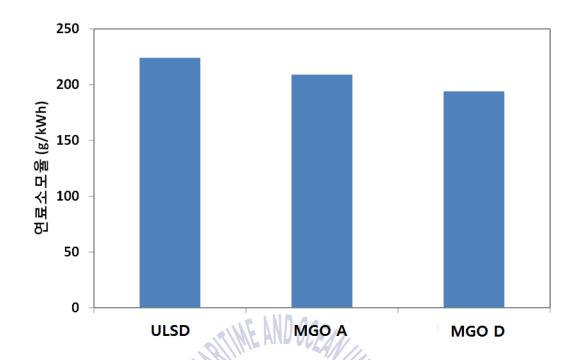
Fig. 4.16 E2 사이클에서 연료 변화에 따른 연료소모율 측정 결과
