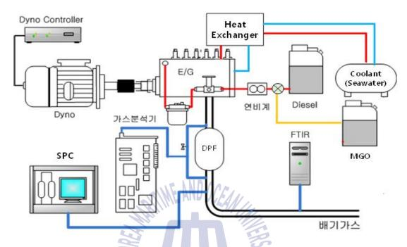
Fig. 4.8 두산 L126TIH 엔진시험 및 배기가스측정 장치 개략도
