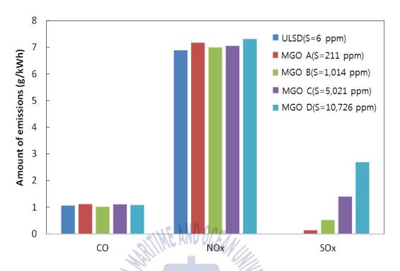
Fig. 4.27 E3 사이클에서 연료 조성 변화에 따른 CO, NOx, SOx 배출량 측정 결과
