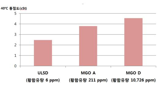
Fig. 3.1 연료유별 40℃ 동점도(kinetic viscosity) 분석 결과
