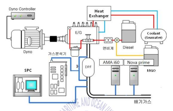
Fig. 4.10 대동 DD6CAM 엔진시험 및 배기가스측정 장치 개략도
