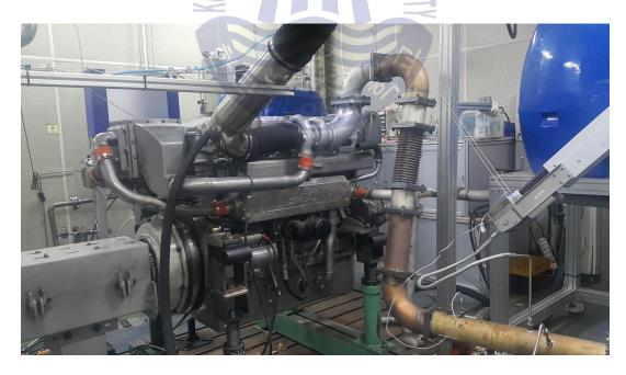
Fig. 4.11 대동 DD6CAM 엔진시험 및 배기가스측정 장치의 전경
