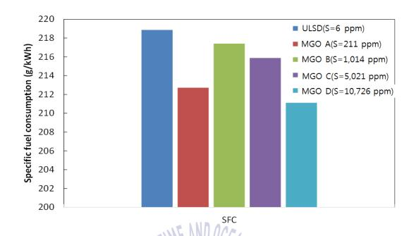
Fig. 4.28 E3 사이클에서 연료 조성 변화에 따른 연료소모율 측정 결과
