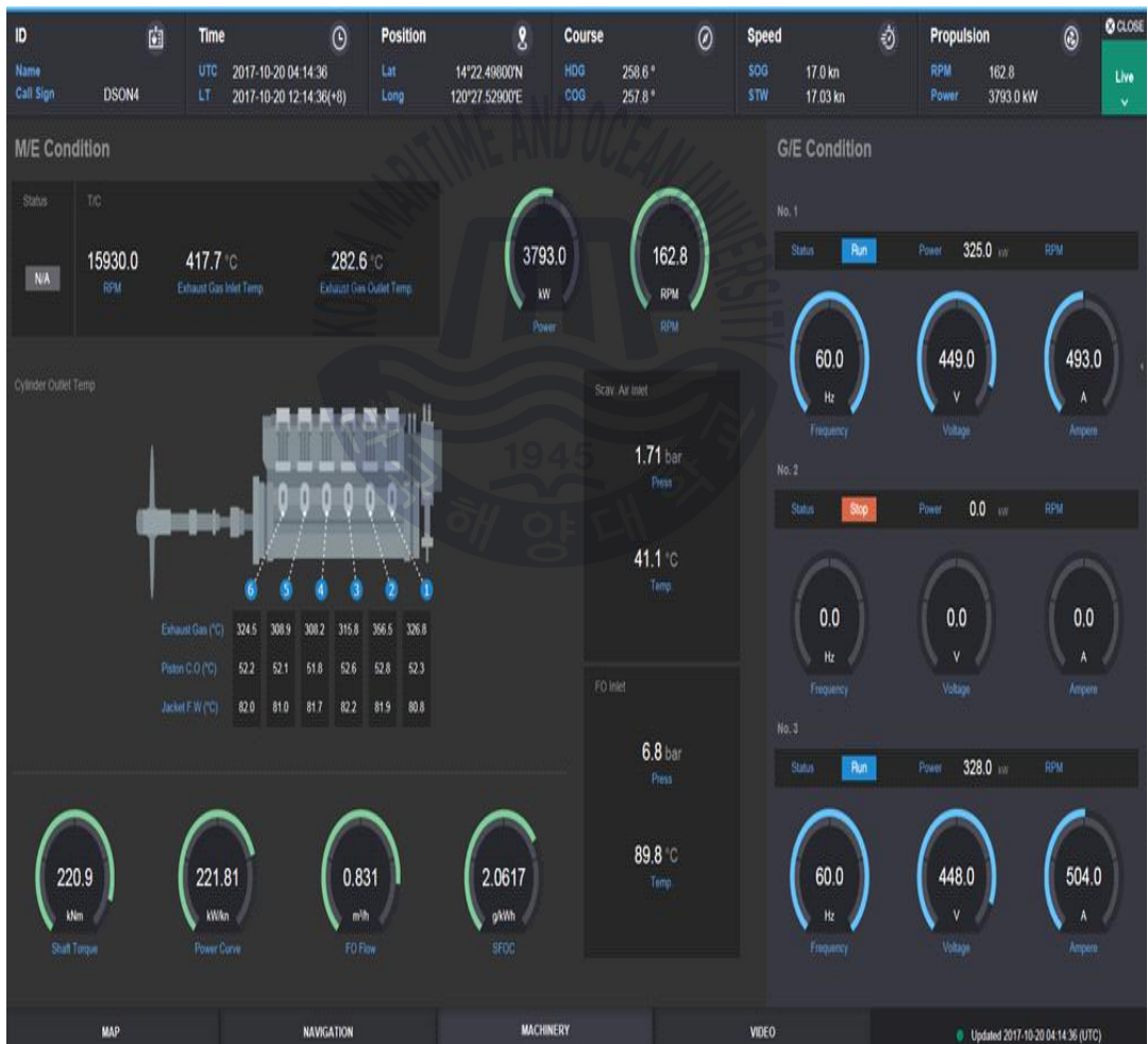
Fig. 3-9 M/E, G/E Monitoring
