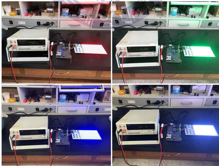
Fig. 77 TCP 제어기의 PWM Duty비율 변화에 따른 전류측정 실험모습
