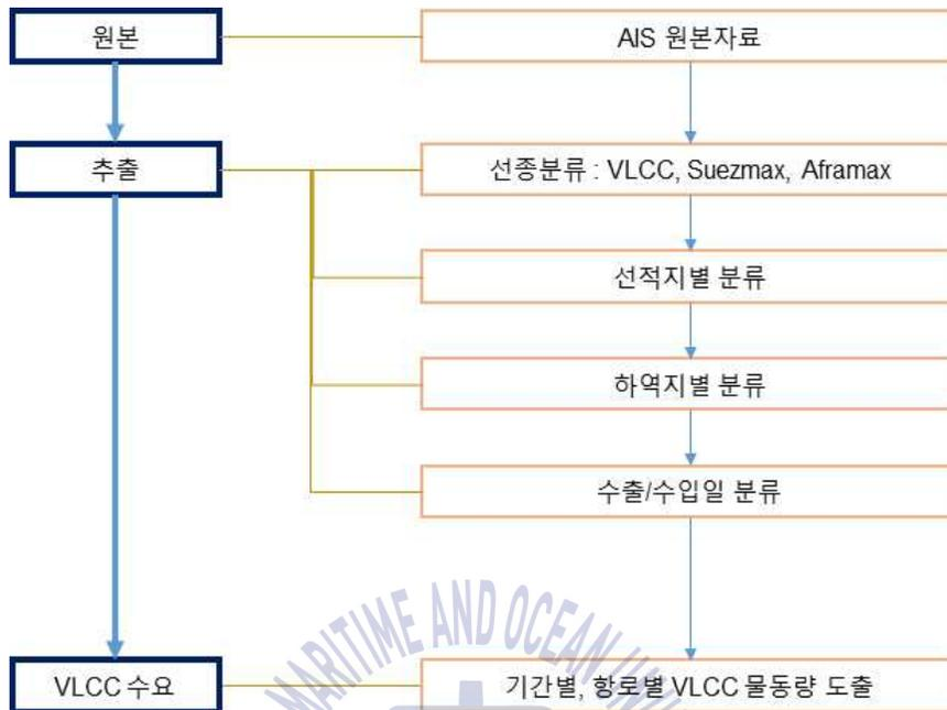
Fig. 5 AIS자료를 이용한 항로별 물동량 추출 흐름도
