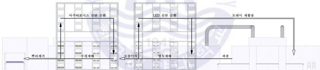
[그림 4-11] 스마트온실 트레이 및 선반 순환 개념도
