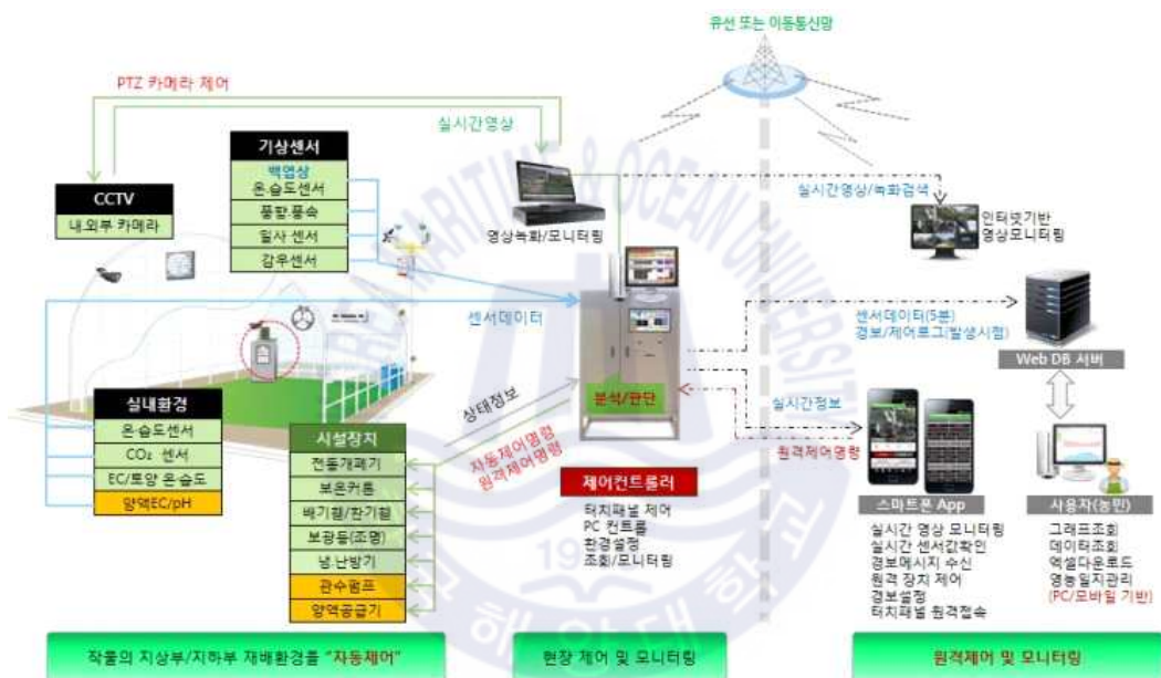
[그림 3-9] 복합환경제어시스템 구성도 87)
