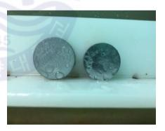
a) 코팅상태 b) 320hr Fig. 38 FCr원료 1000℃ 20hr 코팅된 판재 소재의 염수 분무 부식 시험
