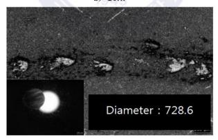
c) 20hr Fig. 29 스테인레스 강의 FCr 950℃ 시간별 마모 시험 결과
