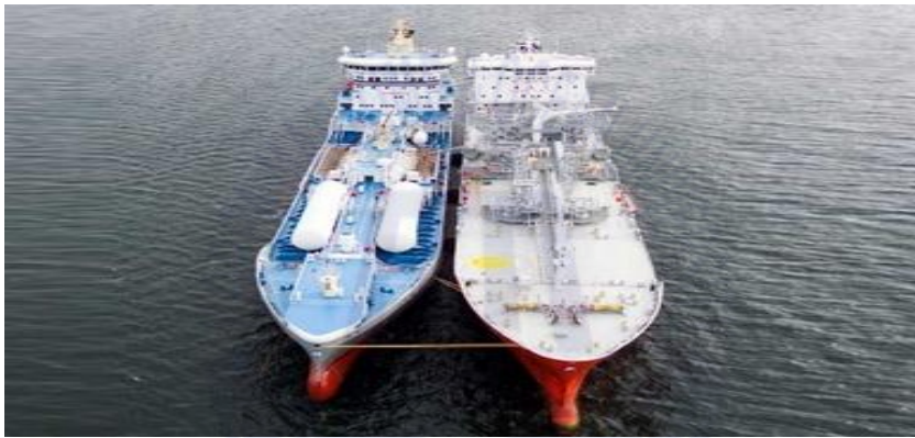
Fig. 2 Ship To Ship(STS) LNG Bunkering
