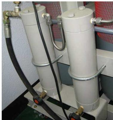
c. Filter(5micron, 1micron)
