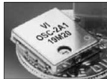
그림 3-8. Vectron사의 Ultra Miniature 10 MHz TCXO
