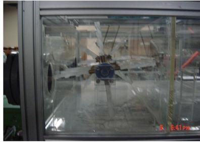
Fig. 3.6 응집지 1단 축방향에서의 패들 블레이드 형상
