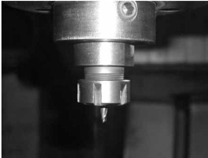
그림 38 oil groove 가공용 ball end mill
