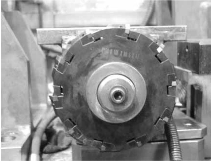
그림 39 oil groove 가공용 wheel cutter
