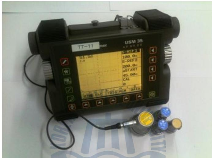
Fig. 4.19 UT apparatus USM 35
