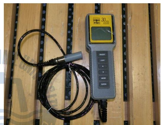
**Fig. 2-13** Salinometer
