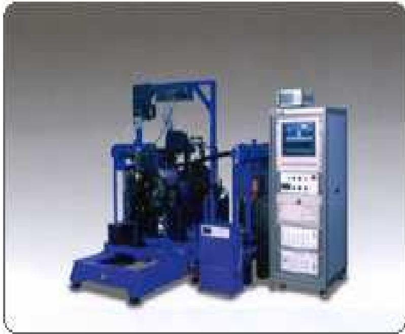
Fig. 3.2 Engine dynamometer
