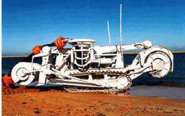
Fig. 2-2 Mechanical cutter식 해저굴삭장비
