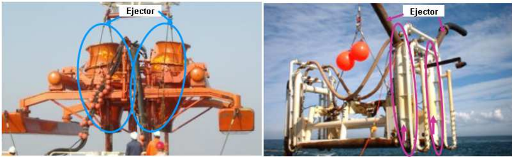
Fig. 3-6 직접 흡입형(왼쪽)과 Air Lift System(오른쪽)
